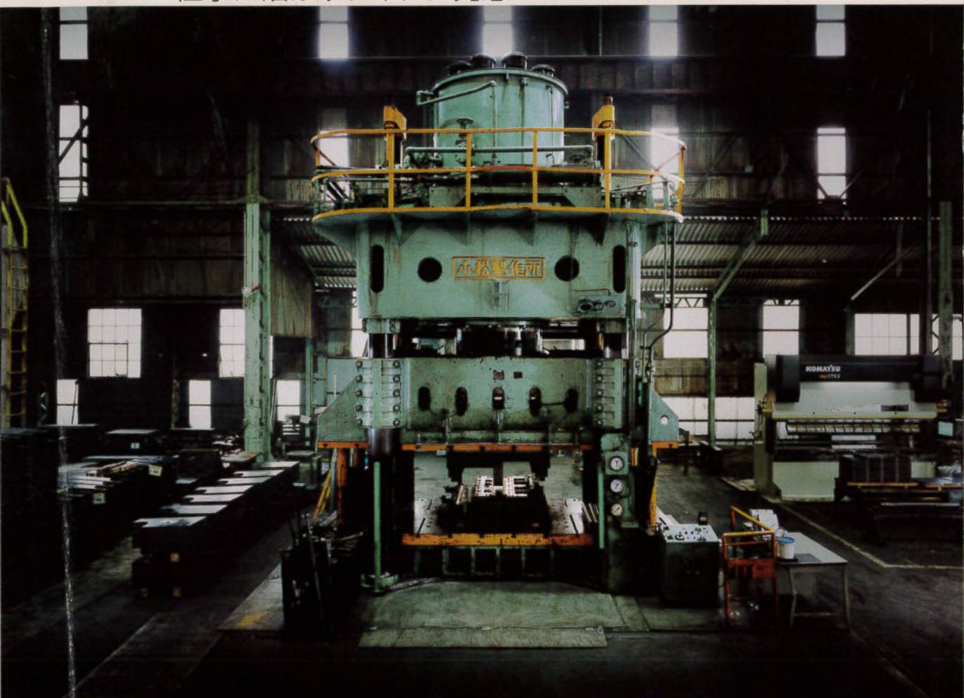
水圧鍛造プレス (1941年製造) 撮影協力 中島プレス工業株式会社 (愛知県名古屋)
