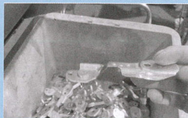
▲ 順送型内ボルト加締め
