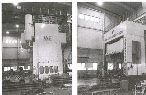
1,000tトライ用メカプレス(左)と、 1,000tトライ用油圧プレス(右)
